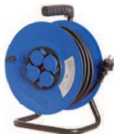
Support tubulaire diam. 19 mm en acier peint. Poignée de transport isolante, tambour incassable en polypropylène D 230 mm. Longueur du câble : 25 m. Puissance MAXI sous 230 V non déroulé : 1000 W, déroulé : 3000 W, 4 prises 2P+T 16 A à volets d'étanchéité : IP 44. Poignée tournante pour l'enroulement. Disjoncteur thermique. Fiche mâle standard indémontable 16 A 230 V.
