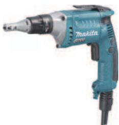
Puissance nominale : 570 W. Puissance nominale débitée (P2) : 260 W. Vitesse à vide max. : 0 à 6000 tr/min. Couple de serrage max. (élast.) : 6 Nm. Couple de serrage max. (franc) : 11 Nm. Capacité : vis plaque de plâtre : 4 mm. Emmanchement d'embouts hex. : 1/4". Taux de vibration triaxial (ah) : <math><2,5 \text{ m/s}^2</math>. Pression sonore (Lpa) : 82 dB (A). Puissance sonore (Lwa) : 93 dB (A). Longueur cordon d'alimentation : 4 m.
