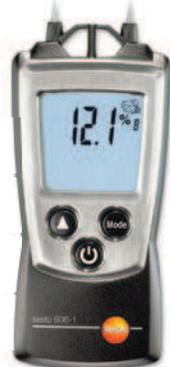
Mesure très précisément l'humidité des matériaux qui est directement affichée en pourcentage par rapport à une masse globale grâce aux courbes caractéristiques des matériaux de construction et du bois mémorisées dans l'appareil. Fonction Hold. Écran rétro éclairé. Protocole d'étalonnage. Fonction Auto-test. Compact, précis et simple d'utilisation. Livré avec étui de ceinture, dragonne et capot de protection.
